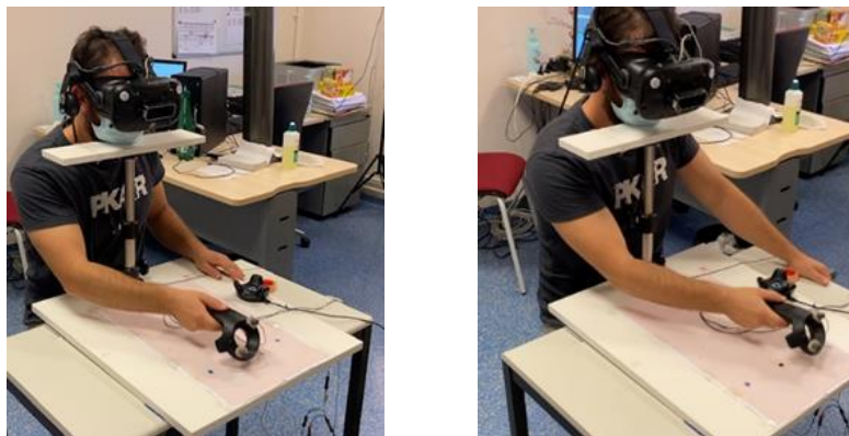
Figure 23 : mesure du SSAm pré-exposition à gauche et post-exposition à droite en condition virtuelle.
