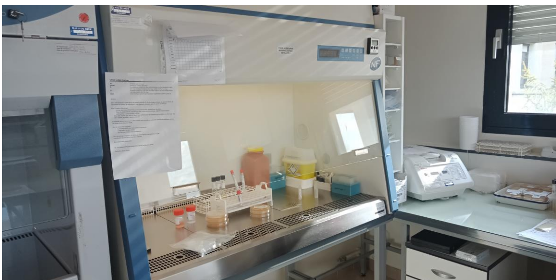
Figure 8. Poste de sécurité microbiologique pour les manipulations des souches de Saccharomyces cerevisiae et de Streptococcus salivarius (PSM, Thermo Fisher Scientific France, Dardilly, France)
