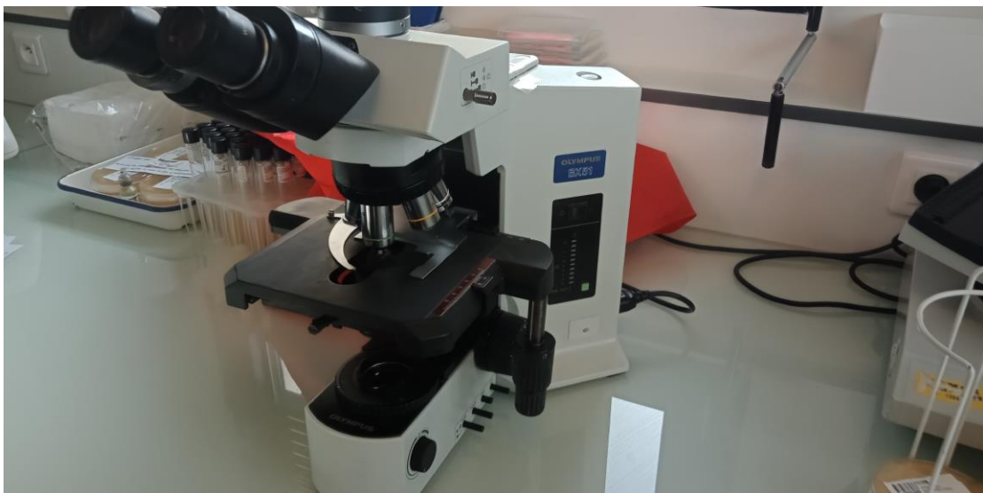
Figure 10. Microscope optique utilisé pour l'observation des cultures en milieu liquide (x 40) (Olympus BX51, Olympus France, Rungis, France)
