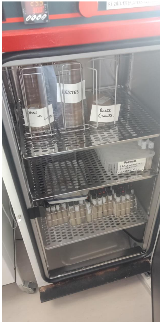
Figure 9. Etuve utilisée pour incuber les cultures à 30°C (Firlabo, Froilabo, Meyzieu, France)
