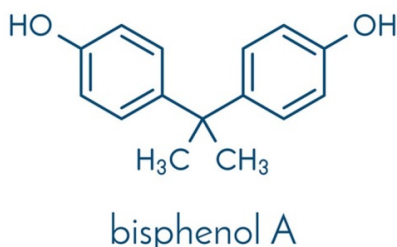
Figure 1: Structure chimique du bisphénol A
