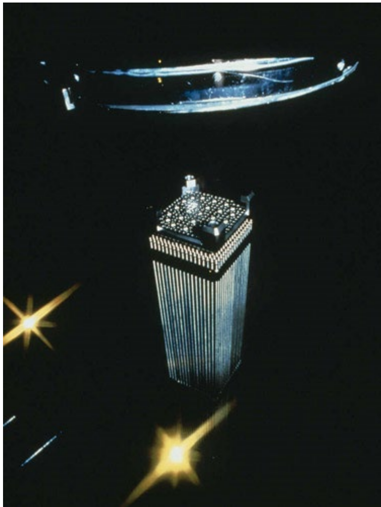
Figure 5 : Assemblage sous eau de combustible de réacteur à eau pressurisée, source : La Radioactivité.com, https://www.laradioactivite.com/site/pages/CombustibleNucleaire.htm , consulté le 5 janvier 2021
