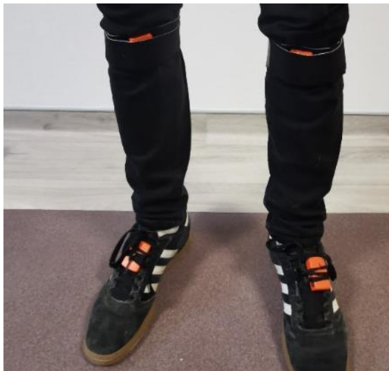
Illustration 10 Photo de gauche : capteurs positionnés au niveau des genoux et des pieds
