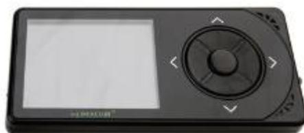
Figure 47 : Récepteur Dexcom G4 <sup>72</sup>
