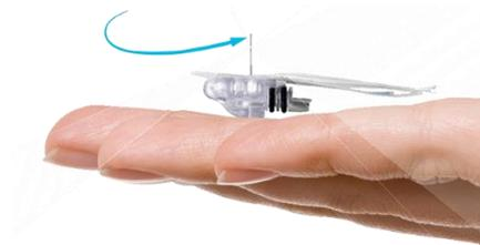
Figure 50 : Capteur Enlite <sup>75</sup>
