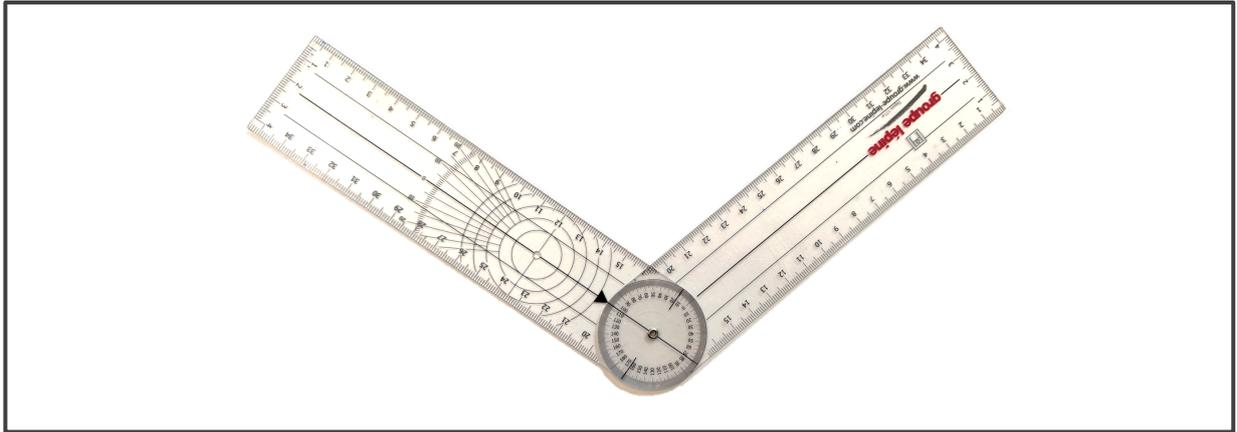
Figure 32 : Goniomètre universel
