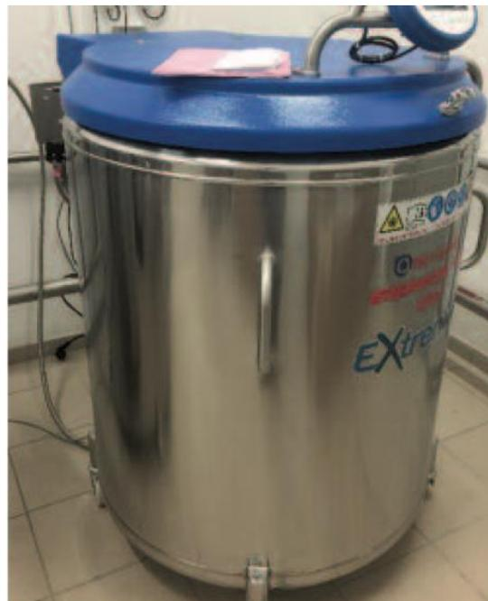
Figure 17 : Cuve d'azote en phase gazeuse(61)
