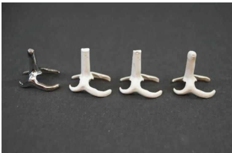
*Figure 13– Crochets issus des 4 groupes de l'étude de Micovic et al, 2020 : chrome-cobalt, PEEK usiné 1 (marque : Dentokeep), PEEK usiné 2 (marque : breCAM bioHPP) et PEEK pressé*
