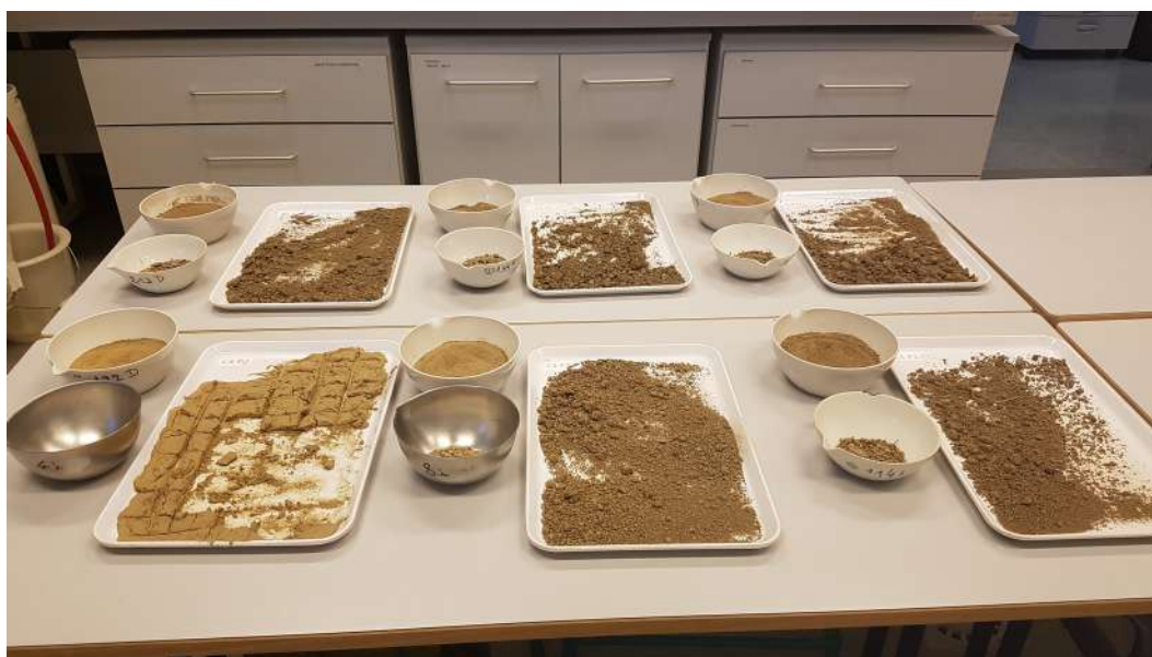
Figure 62 : Répartition des échantillons dans les coupelles après séchage, broyage au mortier et passage au tamis. Source : S.Lecrosnier (14/04/21).
