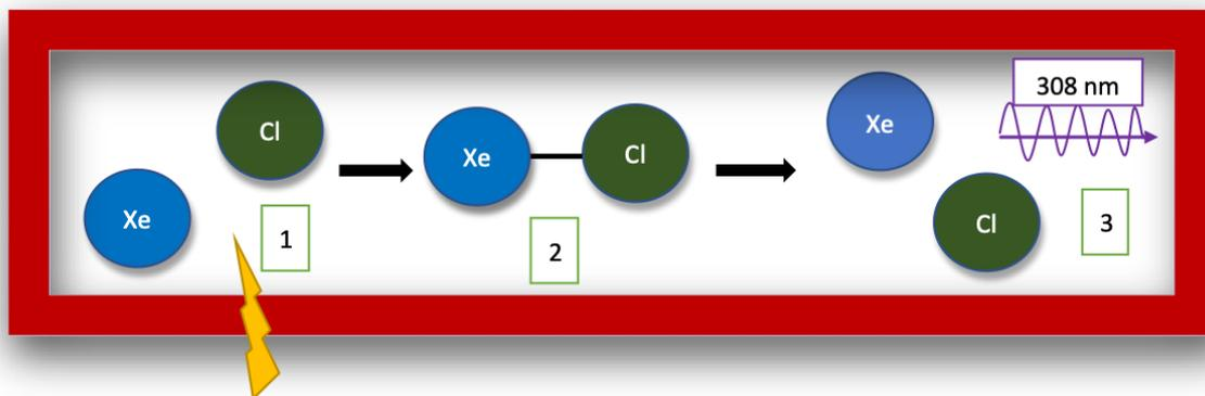
**Figure 22** : Principe du fonctionnement des lasers excimer
