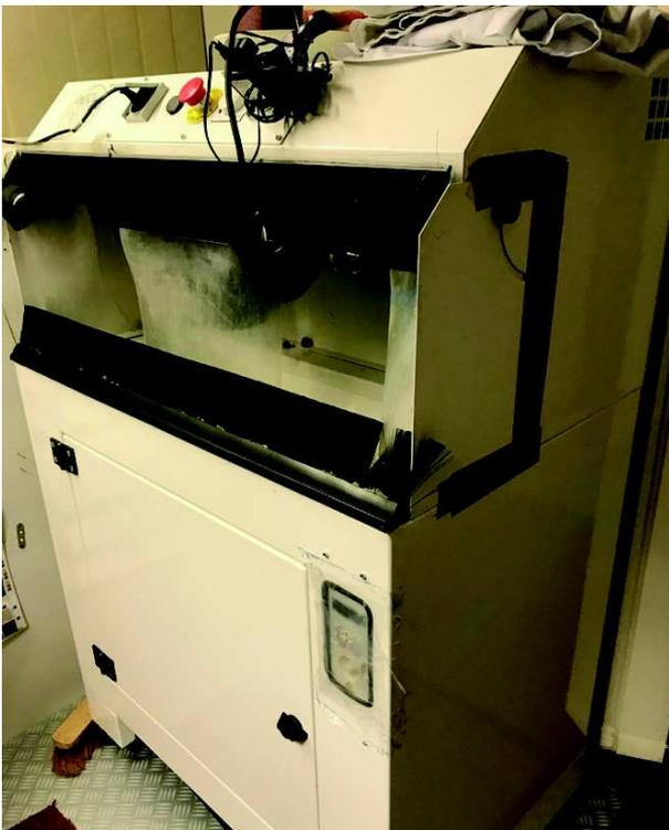
Image 18 : Banc de façonnage avec touret et aspiration
