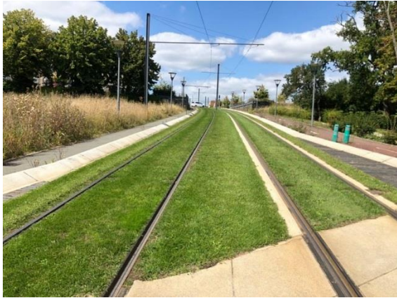
Figure 38 : Aspect visuel du gazon de la zone n°1 (témoin) 4 jours après le début de l'expérience (Orand, 2021)
