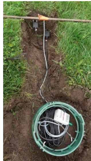
Figure 29 : Sondes d'humidité et de température reliées à un boîtier connecté disposé dans un regard (Orand, 2021)
