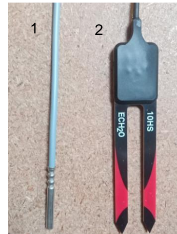
Figure 27 : Sonde de température (1) et sonde capacitive (2) (Orand, 2021)
