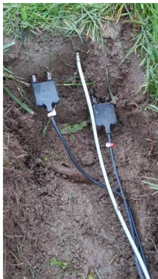
Figure 28 : Sondes d'humidité disposées dans le sol à -5 et -10 cm avec une sonde de température entre 0 et -5 cm (Orand, 2021)
