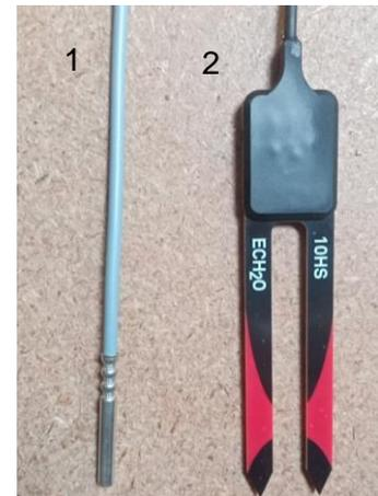
Figure 27 : Sonde de température (1) et sonde capacitive (2) (Orand, 2021)
