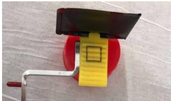
Figure 26 : Photographie du support pour le capteur radiographique, avec son emplacement pour le positionnement du support en silicone. (10)
