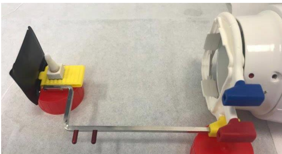
Figure 27 : Photographie du dispositif complet pour la prise des radiographies rétro-alvéolaires des dents sur leur support en silicone. (10)
