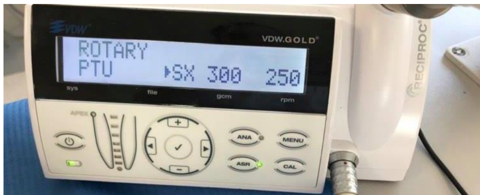
Figure 23 : Photographie du moteur VDW GOLD de RECIPROC® préprogrammé pour l'utilisation du système ProTaper Next. (10)
