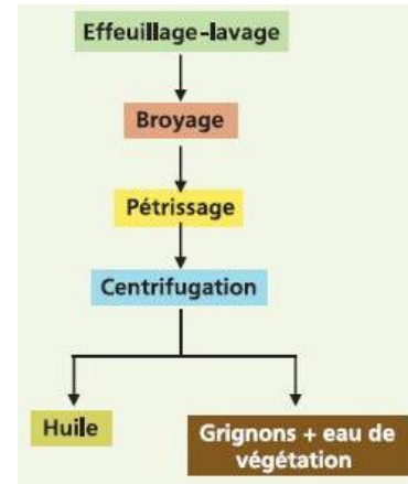
Figure n°15 : Système continu d'extraction avec centrifugation à 2 phases d'après Chimi Hammadi (72)
