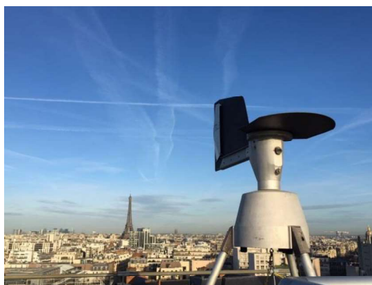
Figure 5 : Photographie du capteur HIRST parisien (Emilie Dalibert, SPSE)
