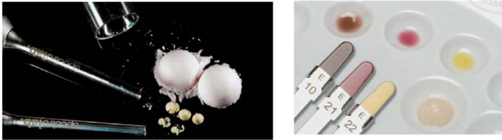
Fig. 40 : les différentes poudres aux doses indiquées par le logiciel sont utilisées par le prothésiste afin de monter sa céramique selon les techniques classiques de stratification à gauche et les différentes teintures E21, E22 et E10 permettant d'ajuster dans l'ordre a^* , b^* et L^* à droite (Hein et al. 2017; Salehi A et al. 2019) ;
