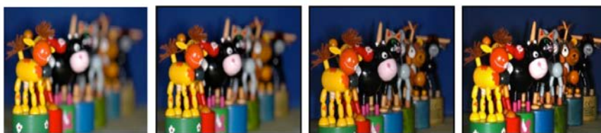
Fig. 30 : effet du nombre d'ouverture sur une même image de gauche à droite : 2,8 ; 4 ; 5,6 et 8 (D'Incau Emmanuel 2016) ;
