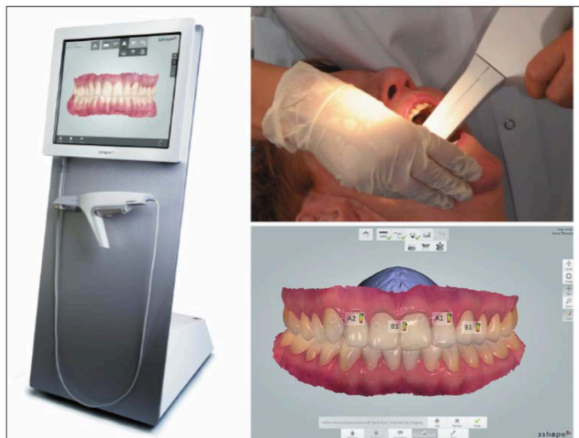
Fig. 13 : caméra orale TRIOS® de 3Shape et son utilisation : relevé de la couleur de la dent en n'importe quel point de la dent (D'Incau E et al. 2014) ;
