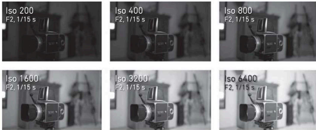
Fig. 32 : effet de la sensibilité ISO sur une même image allant de ISO 2000 à ISO 6400 (Ibrahimi 2019) ;
