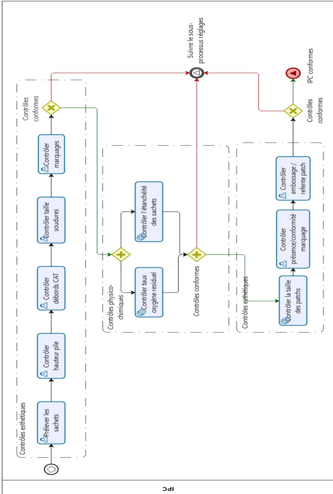
Figure 30 : Sous-processus : Réalisation d'un IPC
