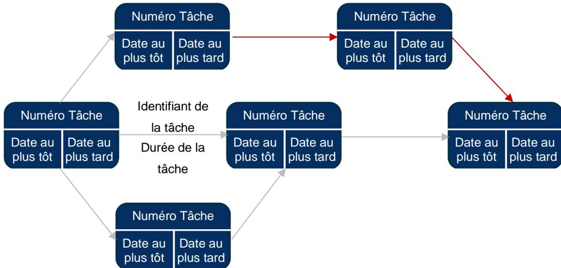
Figure 24 : Modèle d'un diagramme de PERT
