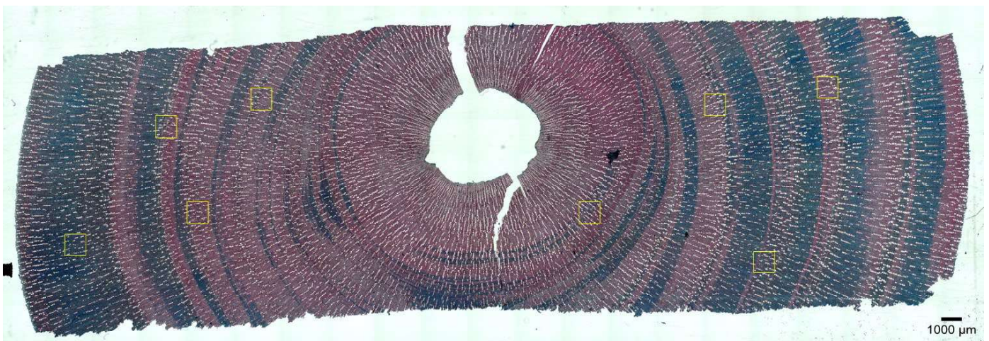
Figure 27 : Individu C1, rondelle 37 (coupe transversale, x20) : exemple de comptage des vaisseaux avec 8 zones d'étude de 1mm x 1mm (carrés jaunes).
