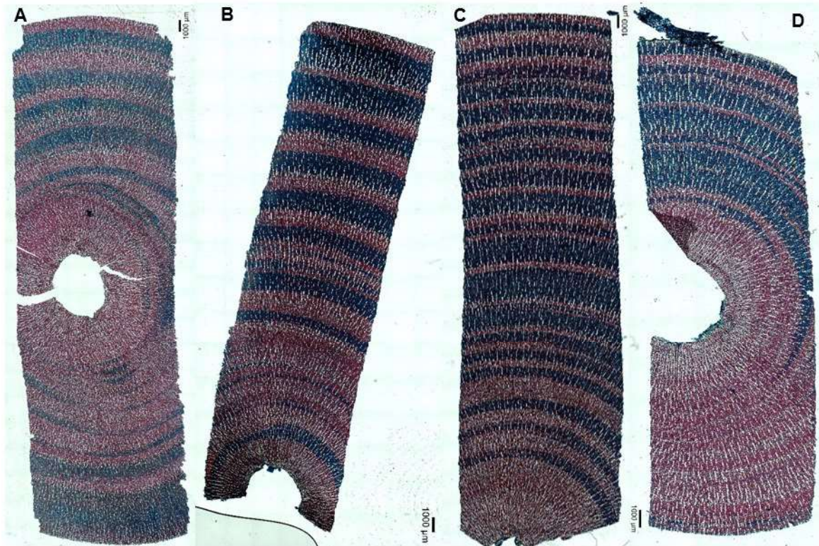
Figure 18 : Coupes transversales des rondelles à 1,30 m chez plusieurs individus montrant la présence régulière et parfois très localisée de bandes de fibres à couche G. Elles sont généralement accompagnées en amont de bande de parenchyme tangentiel. (A) Individu C1, rondelle 37 : on observe environ 9 bandes de parenchyme tangentiel délimitant donc 10 cerne de croissance. Ces bandes de parenchyme sont moins marquées et difficilement identifiables proche de la moelle. Les couches G sont régulières, mais très peu présentes vers le centre de la rondelle. (B) Individu C2, rondelle 24A : on observe environ 12 bandes de parenchyme tangentiel bien marquées, délimitant 13 cerne de croissance. (C) Individu C3, rondelle 37A : on observe environ 21 bandes de parenchyme tangentiel délimitant 22 cerne de croissance. Les bandes de parenchyme sont régulières et plus marquées vers l'extérieur de la rondelle que proche de la moelle. De plus, il n'y a pas de couche G sur les premiers cerne internes de la rondelle. (D) Individu C5, rondelle D : on observe environ 9 bandes de parenchyme tangentiel délimitant 10 cerne de croissance. Les bandes de parenchyme sont bien délimitées et visibles sur toute la rondelle. Les couches G ne sont pas uniformément réparties sur toute la périphérie de la rondelle.
