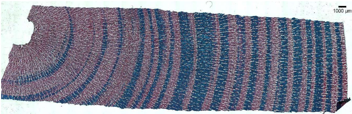
Figure 10 : C. candelabra - individu C3, rondelle 37B (située à 1,30 m de hauteur) : coupe anatomique transversale. La coloration safranine/bleu alcian teinte en rose-rouge la lignine caractéristique des fibres lignifiées du bois « normal » et en bleu la cellulose caractéristique des fibres à couche G du bois de tension. Source : coupe anatomique réalisée par la plateforme SilvaTech
