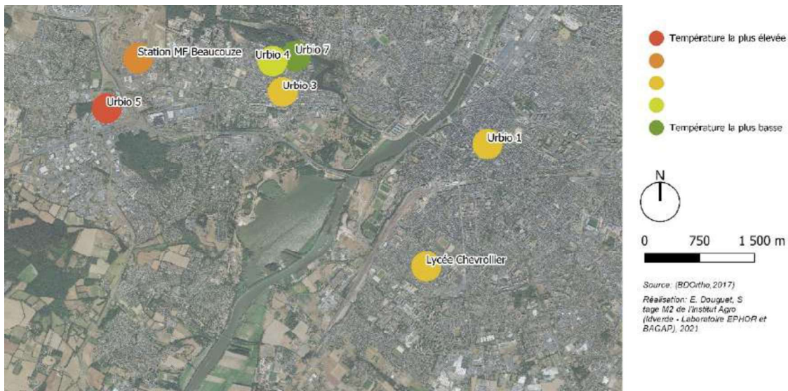
Figure 11: Classement des différents sites selon la température de surface – 26/08/2016 10h56 UTC - Données de l'AURA (Source : E. Douguet)
