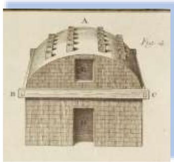
Exemple de four à cuire les tuiles
