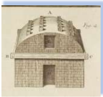
Exemple de four à cuire les tuiles
