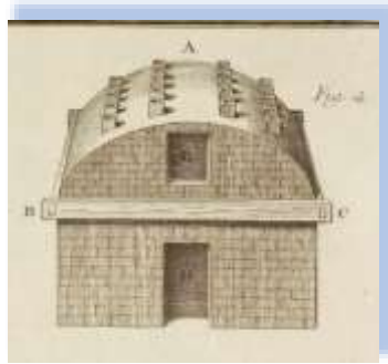
Exemple de four à cuire les tuiles
