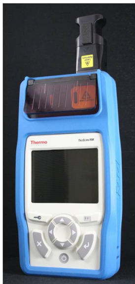
Figure 27: Spectromètre Raman portatif Truscan
