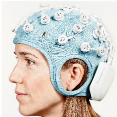
*Figure 8: Bonnet anatomique utilisé dans notre protocole pour positionnement des électrodes*
