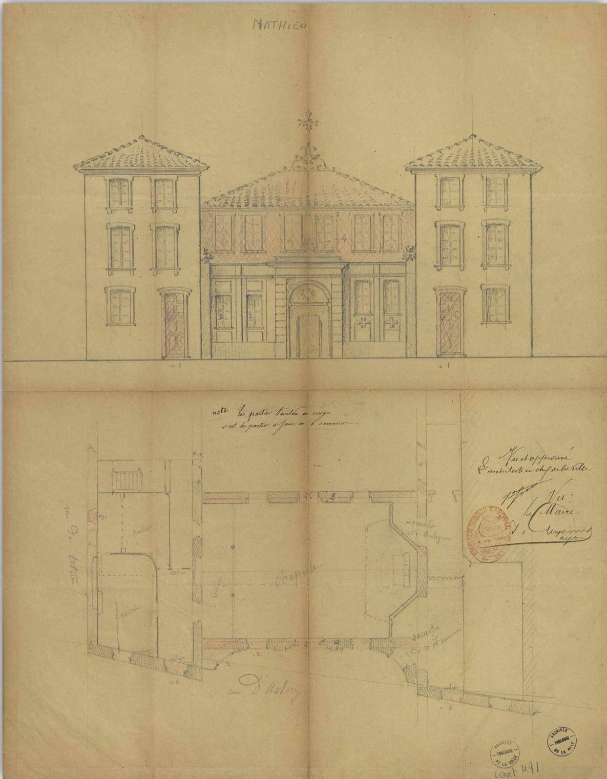
*Projet d'exhaussement de l'arrière corps et modification d'ouvertures, 11 rue d'Astorg, juillet 1890<sup>204</sup>*
