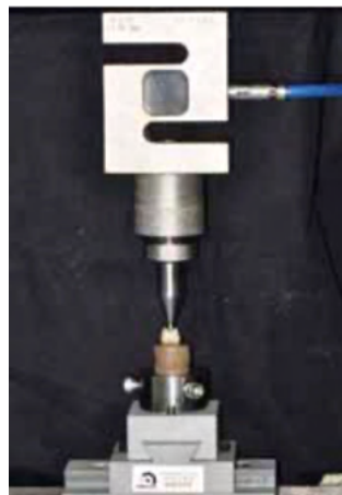
Figure 57 : Test de fracture par une machine universelle (source : Overlays or Ceramic Fragments for Tooth Restoration : An Analysis of Fracture Resistance. 2014 )
