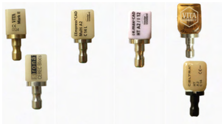
Figure 39 : Exemples de blocs céramiques pour CFAO (source : Nasr et al, 2015)
