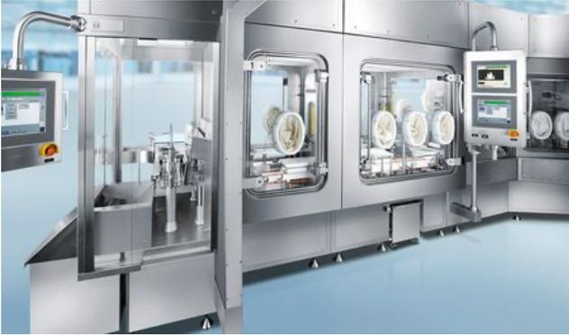
L'isolateur est un espace clos avec un environnement aseptique maîtrisé et une qualité d'air de classe A (ISO 5). Il constitue une barrière physique entre l'opérateur et le produit, et il est utilisé pour protéger le produit, l'opérateur et l'environnement. De plus, l'isolateur peut également subir une biodécontamination intérieure reproductible et validée. (8)
