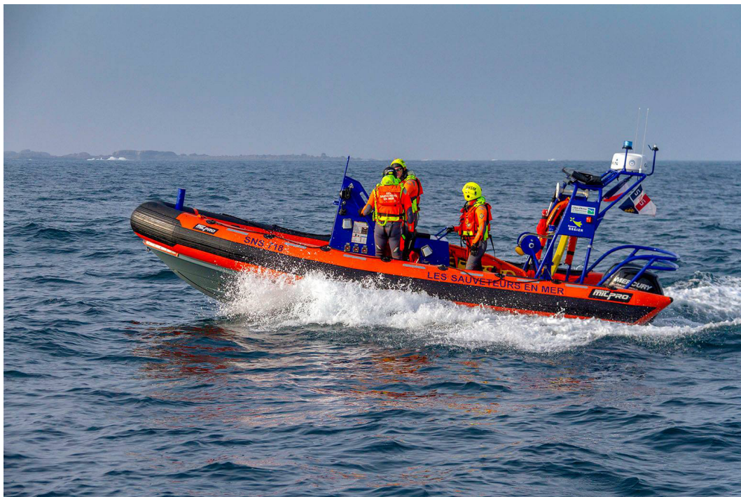
Figure 4.3 : Disposition du SR, la victime est installée à l'arrière en travers, callée contre le roll-bar (portique bleu).
