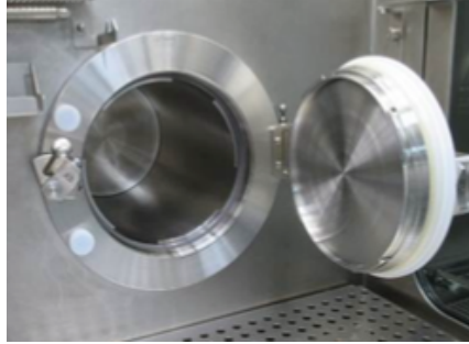
Figure 58 : Porte DPTE® ouverte depuis l'intérieur de l'isolateur sur site
