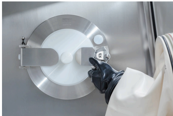
Figure 56 : Intérieur de l'isolateur sur site : partie alpha
