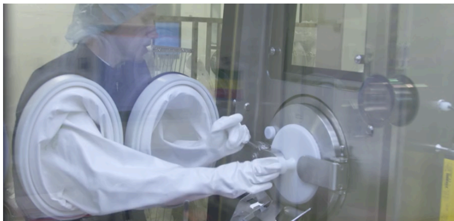
Figure 57 : Ouverture de la porte DPTE® depuis l'intérieur de l'isolateur sur site
