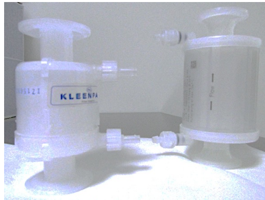
Figure 34 : Exemple de matériel poreux : les filtres (photographie prise sur site)
