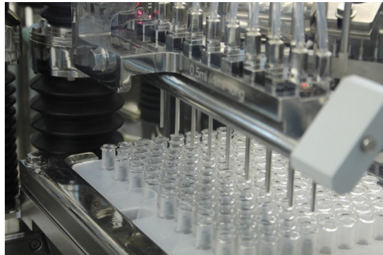
Figure 46 : Aiguilles de remplissage au dessus des seringues vides (photographie prise sur site)
