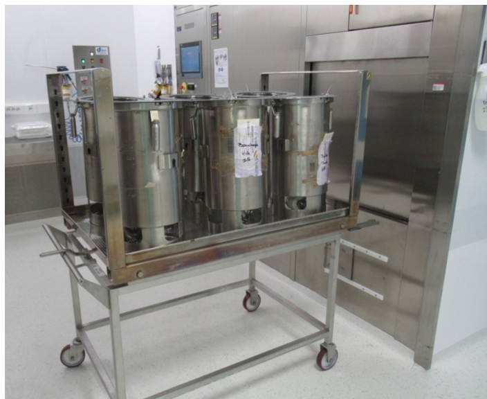
Figure 59 : Une charge de 6 canisters prêts à être introduits dans l'enceinte de l'autoclave sur site
