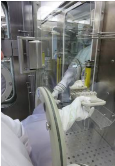
Figure 47 : Manipulation de montage de la ligne par l'intermédiaire de gant (photographie sur site)
