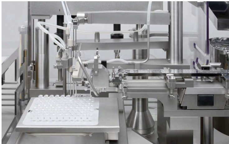
Figure 14 : Station de remplissage dans l'isolateur (photographie prise sur site)
