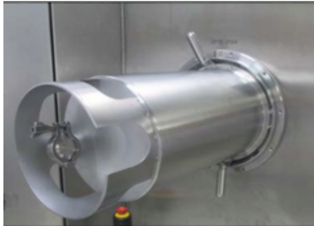
Figure 49 : Canister connecté à l'isolateur (photographie prise sur site)
