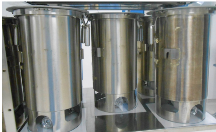
Figure 48 : Position horizontale des canisters dans l'autoclave (photographie prise sur site)
