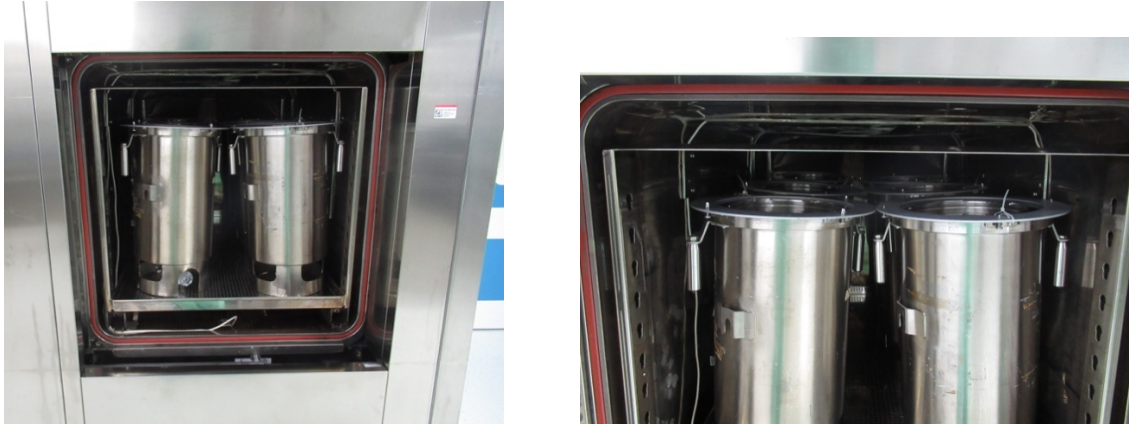
Figure 60 : Charge de 6 canisters dans l'autoclave sur site prête à être stérilisée
