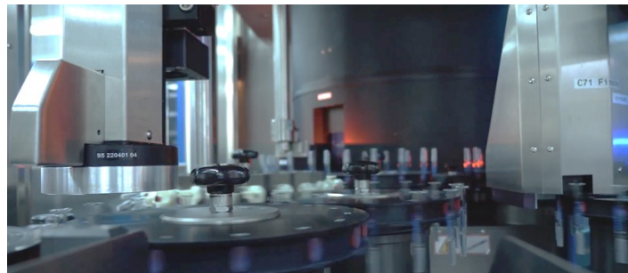
Figure 21 : Illustrations de mireuse automatique sur site
