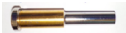
Figure 35 : Exemple de matériel non poreux : un tube d'introduction (photographie prise sur site)
