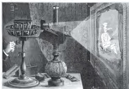
Fig 273 : Exemple de Praxinoscope-théâtre avec lanterne magique de projection
