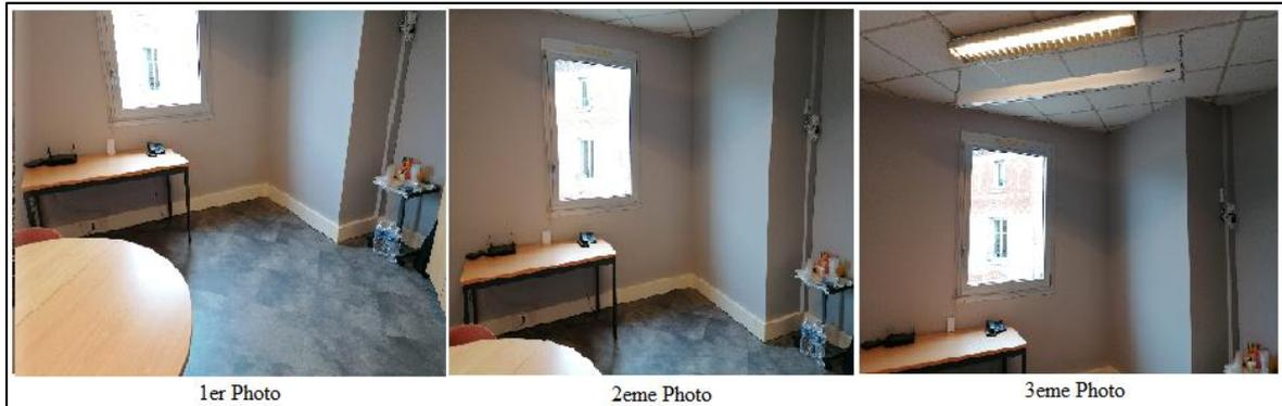
Figure 9 : Exemple d'étape de photo à prendre lors d'un levé d'intérieur via un smartphone. La première photo capture le sol et le plus de détails possible à environ 2 m du mur. La deuxième photo est prise sur la même position un peu plus haut, en gardant environ 75% de recouvrement par rapport à la précédente. Pour finir la troisième photo prend le plafond avec encore le recouvrement à respecter et la même position de caméra.
