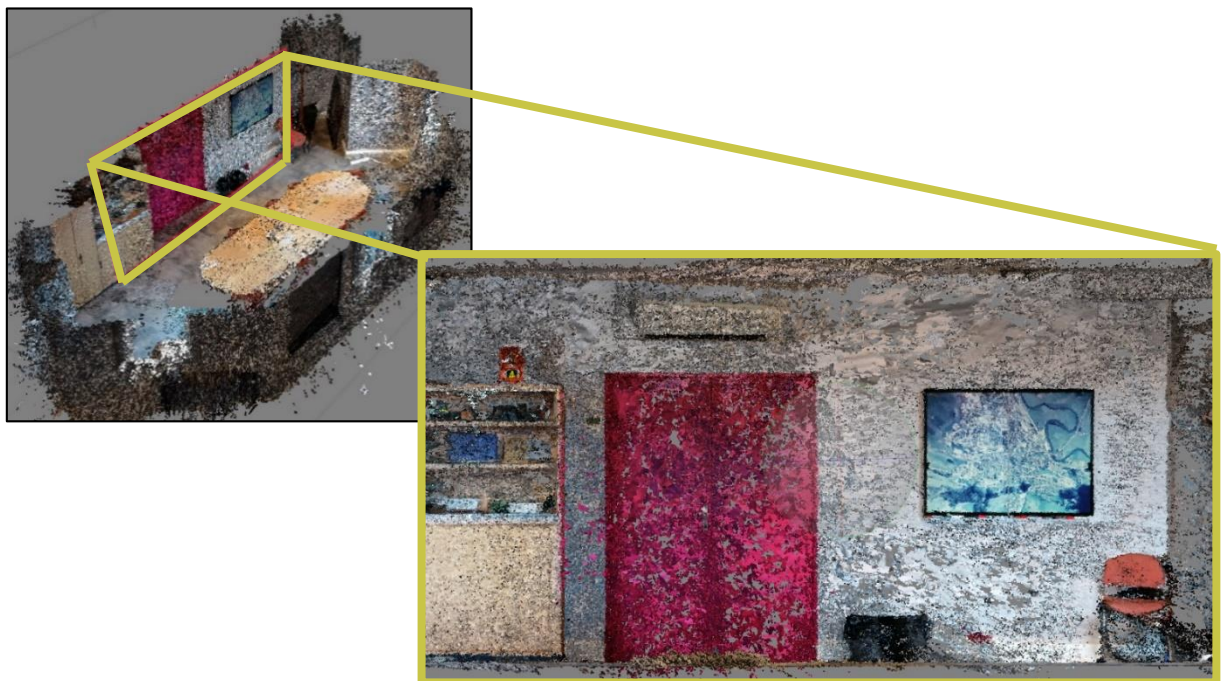
Figure 3 : Extrait du nuage de points 3D de la salle de réunion A gauche de l'image l'armoire, au centre la porte d'entrée de la salle de réunion de couleur violette et à droite de l'image le tableau
