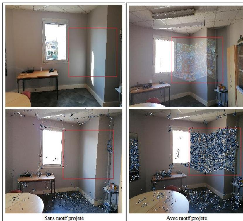
Figure 5 : Comparaison des points homologues avec la projection d'un motif sur un mur uni
