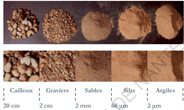
Fig.98 - Les différents types de grains d'une terre à pisé, amaco.
