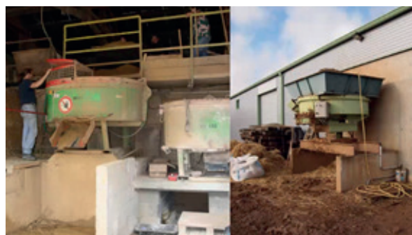
Fig.171 - Malaxeur de terre à bauge et à torchis de l'association «des artisans du torchis» en Normandie, photographies de François Streiff.
