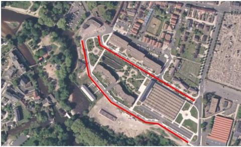
Figure n° 31 : rues dans le sens d'écoulement de l'eau et parallèles à la rivière
