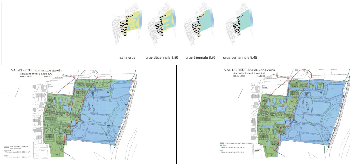
Figure n° 21 : plans de simulation des différents niveaux de crues au sein du projet
