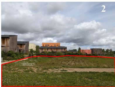
Figure n° 40 : vue sur l'espace public paysager assurant aussi la fonction de stockage des eaux Source : réalisation personnelle
