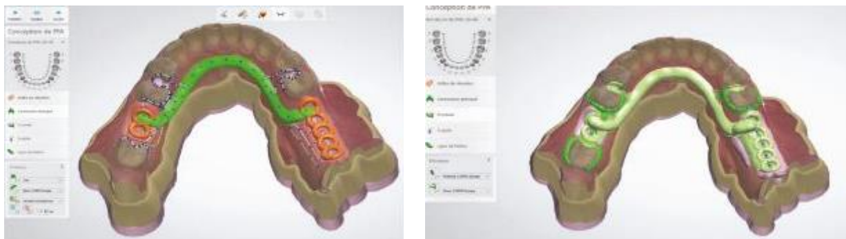
Figure 28 : Conception de l'armature d'un châssis en essayant différents gabarits proposés par le logiciel CAO
