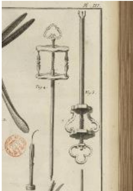
Figure 55 : Présentation des tire-balles. DIDEROT Denis, D'ALEMBERT Jean, Encyclopédie ou Dictionnaire raisonné des sciences, des arts et des métiers , Paris, chez Briasson, David, le Breton, Durand, 1751-1772, volume III, planche III.
