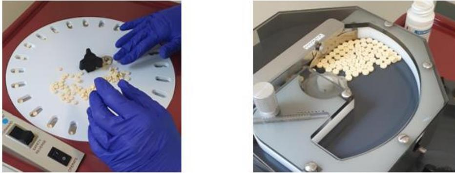
Figure 12 : mise en place manuelle des comprimés dans les alvéoles de l'automate (à gauche) et déversement automatique des comprimés (à droite)
