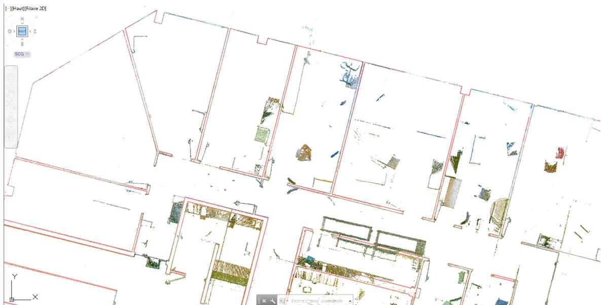
Figure 13 : Capture d'écran de la superposition du nuage fait en plusieurs sessions de balayage et du plan dessiné à partir de la solution statique. Source N. Amadiou
