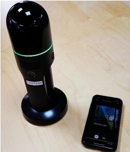
Avec le développement du BIM, les maquettes numériques, les modèles 3D et les premiers scanners dynamiques, Leica Geosystems, entreprise Suisse a commercialisé en décembre 2019 son premier scanner dynamique IMMS, le BLK-To-Go. Cet appareil répond ainsi aux besoins des différentes entreprises pour la création de modèles et apporte des innovations aux solutions dynamiques préexistantes (Figure 5).
