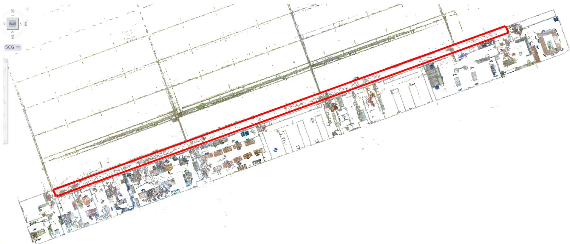
Coupe du nuage de points réalisé au BLK-To-Go de l'étage 2 des locaux du grand magasin, avec en rouge la position du couloir commun à toutes les salles. Par cette configuration des lieux, il était impossible de réaliser un cheminement fermé, c'est pourquoi le cheminement de lever était en antenne.
