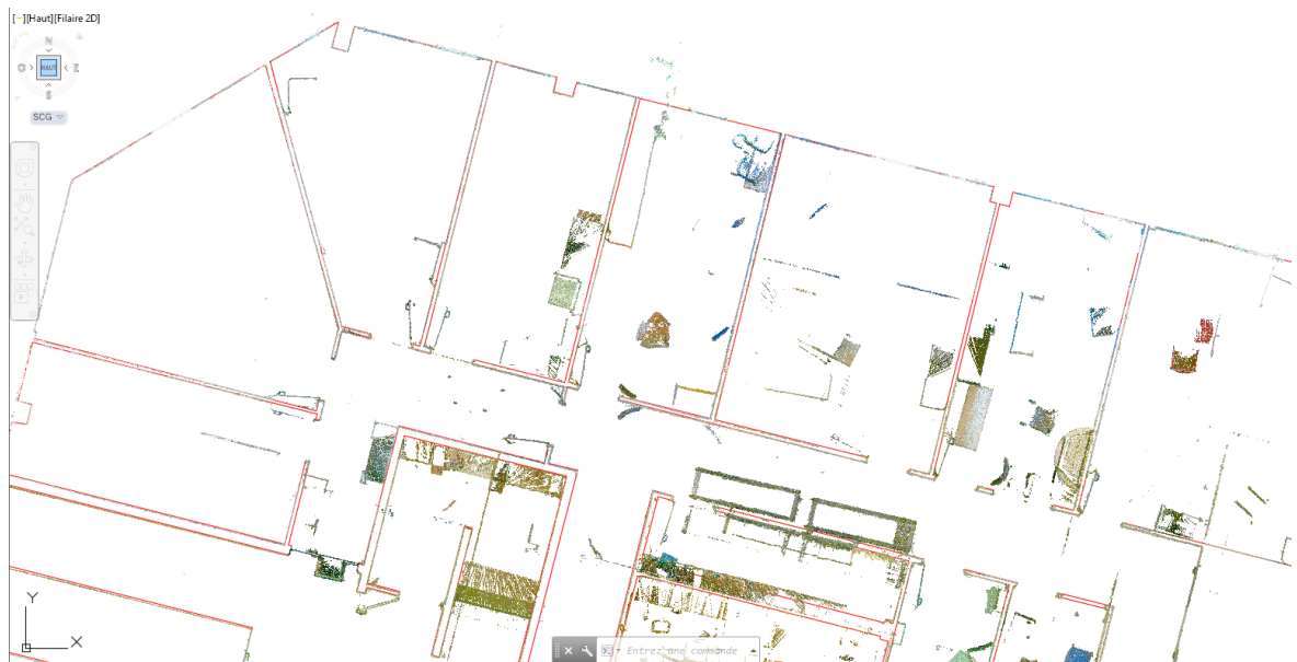
Figure 13 : Capture d'écran de la superposition du nuage fait en plusieurs sessions de balayage et du plan dessiné à partir de la solution statique. Source N. Amadiou
