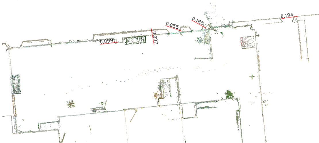
Figure 15 : Capture d'écran de la coupe du nuage avec les écarts entre les éléments du décor scannés en double. Source N. Amadiou
