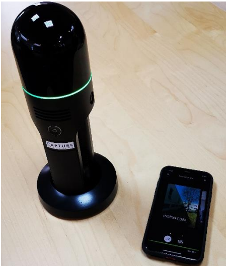
Figure 5 : BLK-To-Go sur sa base et le téléphone pour la visualisation du nuage. Source N. Amadiou
