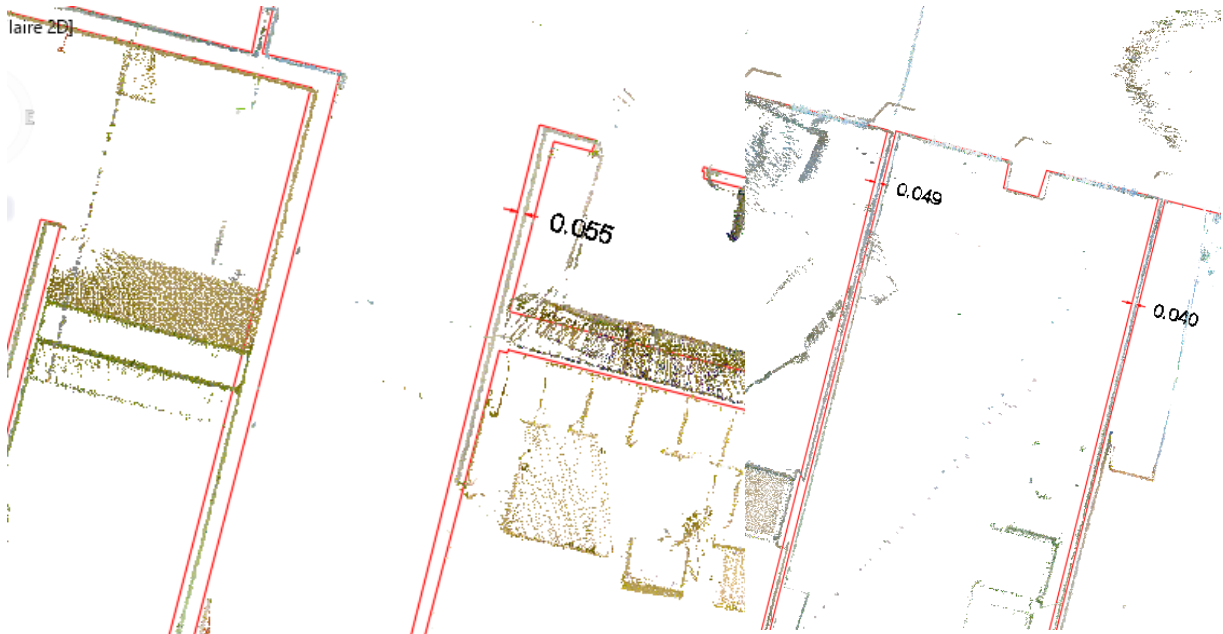
Figure 14 : Capture d'écran de la superposition du nuage fait en une seule session de balayage et du plan dessiné à partir de la solution statique. Source N. Amadiou
