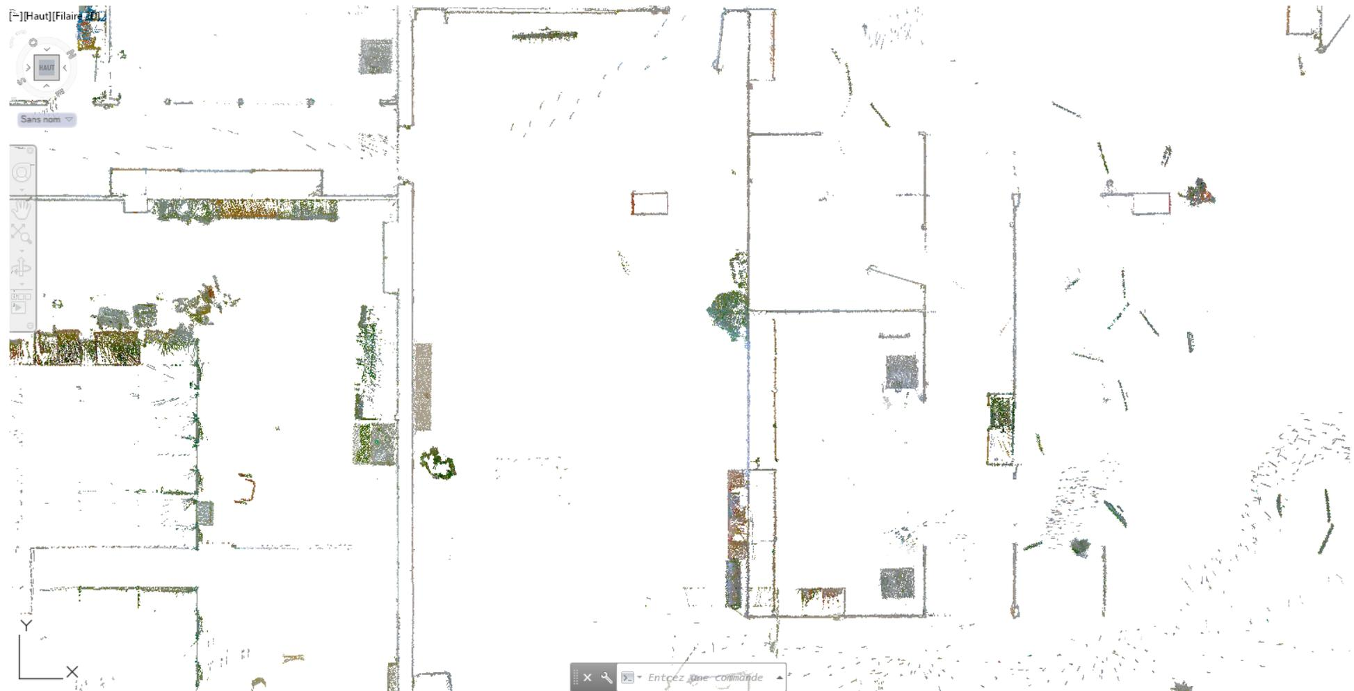
Nuage issu du scanner dynamique BLK-To-Go. Sur cette coupe en plus du bruit de la mesure qui est de 2 cm, les murs sont droits et les phénomènes d'angle arrondis faibles, permet peu d'estimations de la part du dessinateur pour réaliser des plans de cet intérieur, la seule estimation se situe au niveau du bruit de la mesure qui est le double de celui du NavVis VLX.
