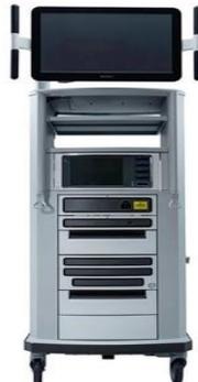
Figure 27- La colonne vidéo du robot Da Vinci® Xi (41)
