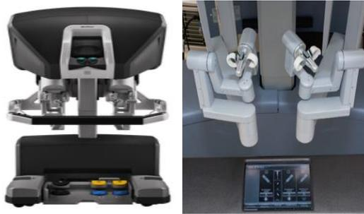
Figure 26 - Console du robot Da Vinci Xi® et manipulateurs du robot Da Vinci Xi® (41)
