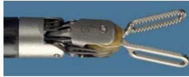
Figure 23 - Poignet Endowrist® de la pince bipolaire fenêtrée 8 mm (42)
