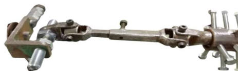
Figure 4 : détail du double cardan.
