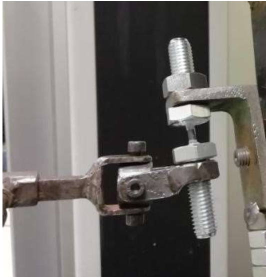
Figure n°5 : connexion sur le banc expérimentale par les vis.
