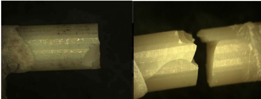
Figure 21 : photographies du profil de rupture des échantillons n°2 et n°10.
