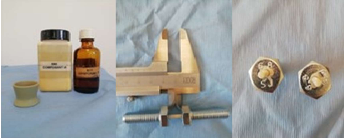
Figure 7 : colle à jauge ; pied à coulisse avec le montage réalisé ; assemblage d'une extrémité de barre cylindrique de zircone dans une vis de montage.
