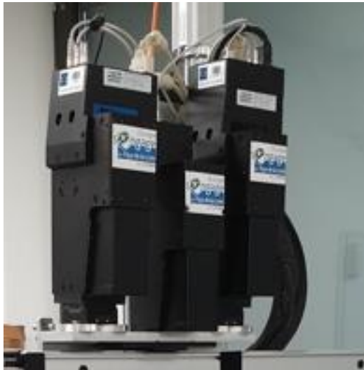
Figure 14 : Les trois caméras hyperspectrales du laboratoire de Nantes (LPG). Source osuna.univ-nantes.fr
