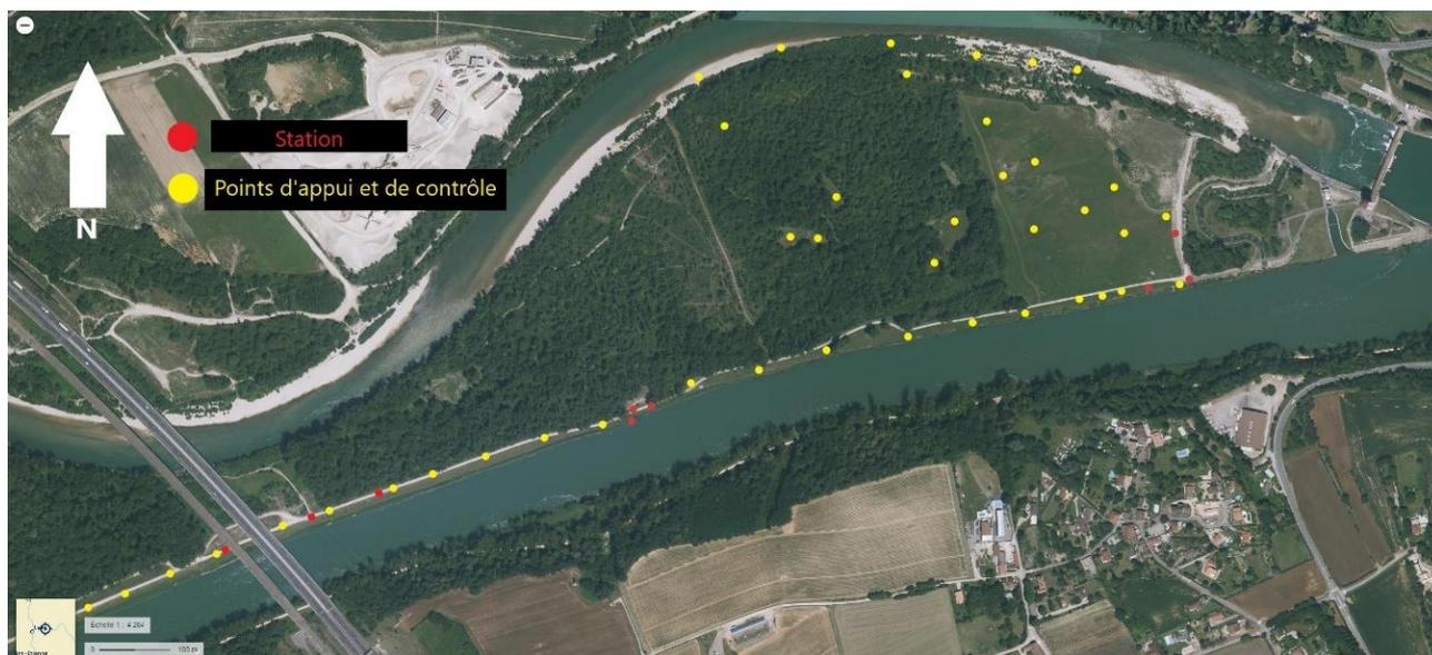
Figure 28 : Plan de situation des points d'appui et de contrôle au sol d'une partie du chantier (geoportail.gouv.fr)
