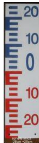
Figure 26 : Echelle limnimétrique (TPLM-3D)
