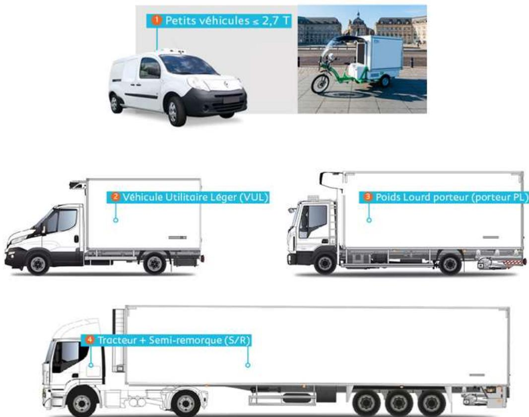
Figure 6 : Exemples de véhicules utilisés dans le transport en température dirigée (51).
