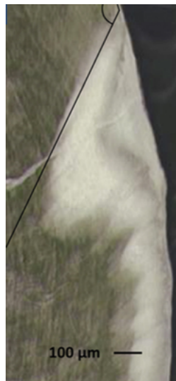
Figure 1 : white spot en coupe transversale, observé au microscope optique (1)
